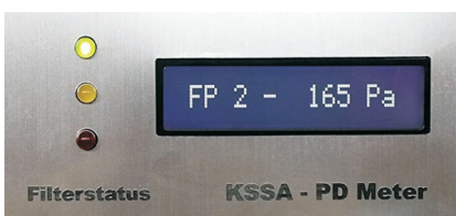
Senzorická jednotka tlakových ztrát filtrů
